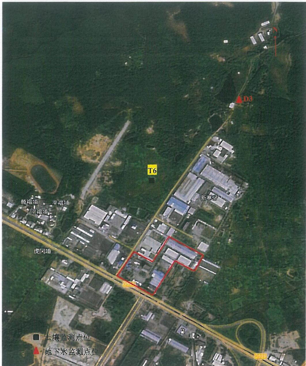
图 5-2 土壤、地下水对照点监测布点图
